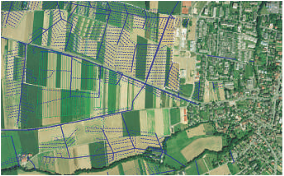
7 Ein riesiges Netz von eingedolten Bächen, Drainageröhren, Sammlern und Saugern durchzieht das Landwirtschaftsland, wie beispielsweise hier bei Therwil.
