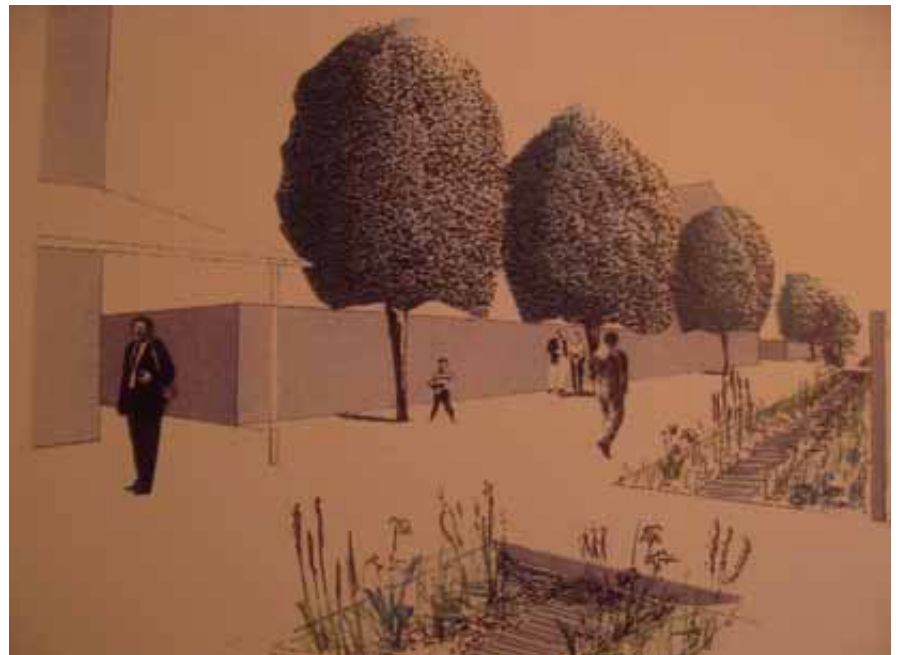
Abb. 63: Das siegreiche Wettbewerbsprojekt (Rosenmund & Rieder/oekoskop) sah entlang der Stichstrassen der Siedlung bei Rümplingen (D) ein Netz von naturnahen Entwässerungsgräben vor, die im Verbund mit Naturschutzteichen stehen.
